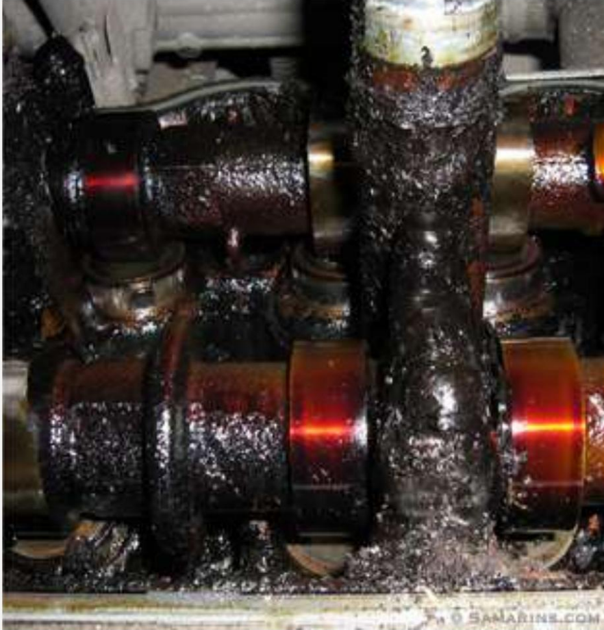
Motor mal mantenido a los 80.000 km.
